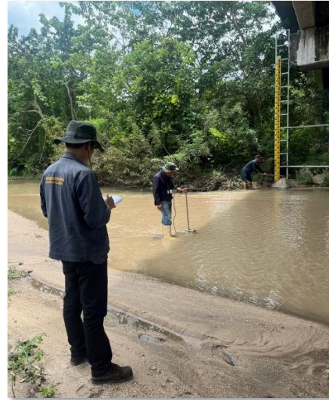
รูปที่ 5.2.2-1 การสำรวจปริมาณน้ำและตะกอนแขวนลอยสถานีสำรวจอุทกวิทยาทางน้ำห้วยแม่ป่าไผ่
