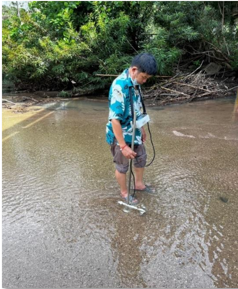
รูปที่ 5.2.2-1 การสำรวจปริมาณน้ำและตะกอนแขวนลอยสถานีสำรวจอุทกวิทยาทางน้ำห้วยแม่ป่าไผ่
